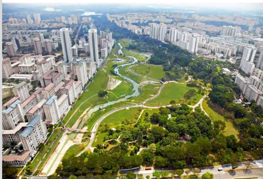
A sn. un'immagine della situazione del fiume Kallang precedentemente canalizzato. L'intervento ha previsto la demolizione dell'alveo in cls, lo scavo del nuovo alveo e la sistemazione delle sponde.
